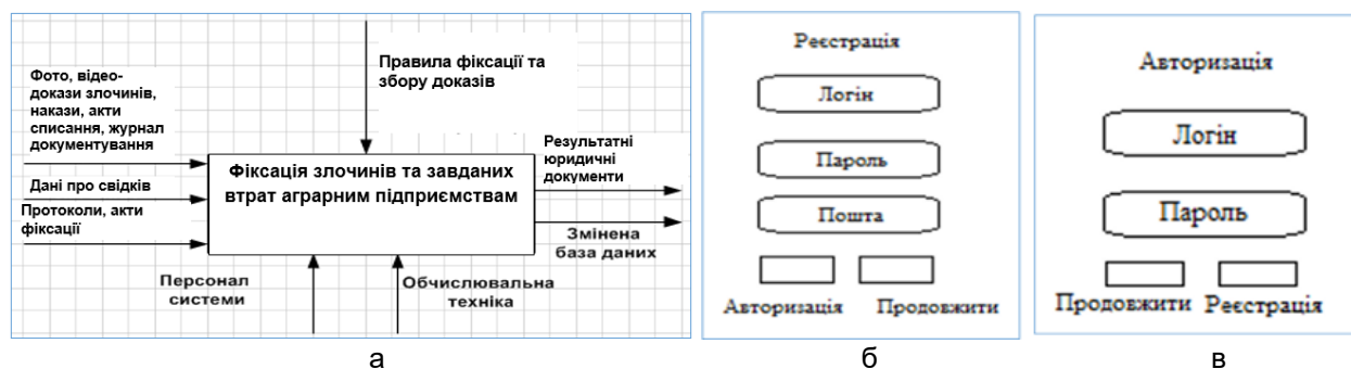
Рисунок 1 – Структурні та інтерфейсні компоненти веб-додатку фіксації злочинів і втрат аграрних підприємств: а) контекстна діаграма веб-додатку; б) прототип інтерфейсу сторінки реєстрації користувача; в) прототип інтерфейсу сторінки авторизації
