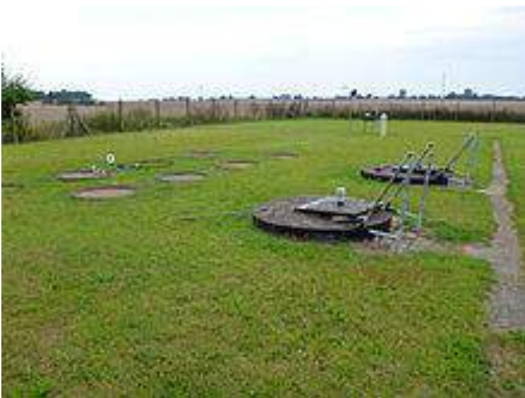
Рис. 2.4 Лізиметр, що має окремий вхід для збору рідини
