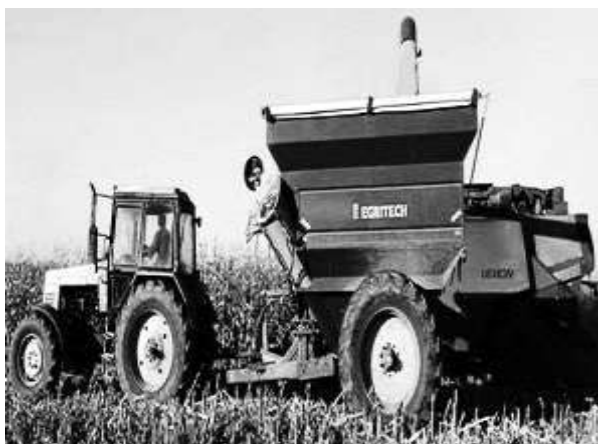
Рис. 2 – Приймання зерна від комбайна перевантажувачем
