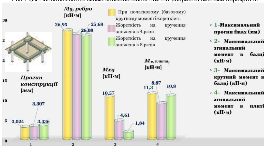
Рис. 2 Максимальні значення параметрів НДС в скінчено-елементній схемі
