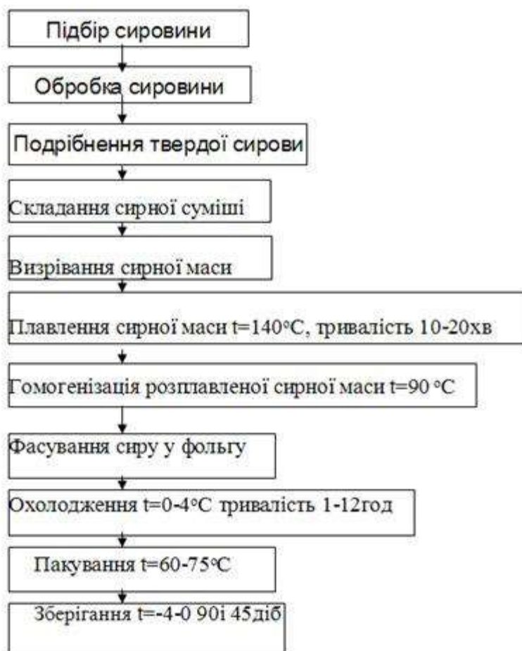
Рис. 1. Загальна технологічна схема виробництва плавлених сирів
