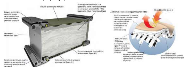
Рисунок 3. Утеплювальний прошарок та його розміщення всередині
