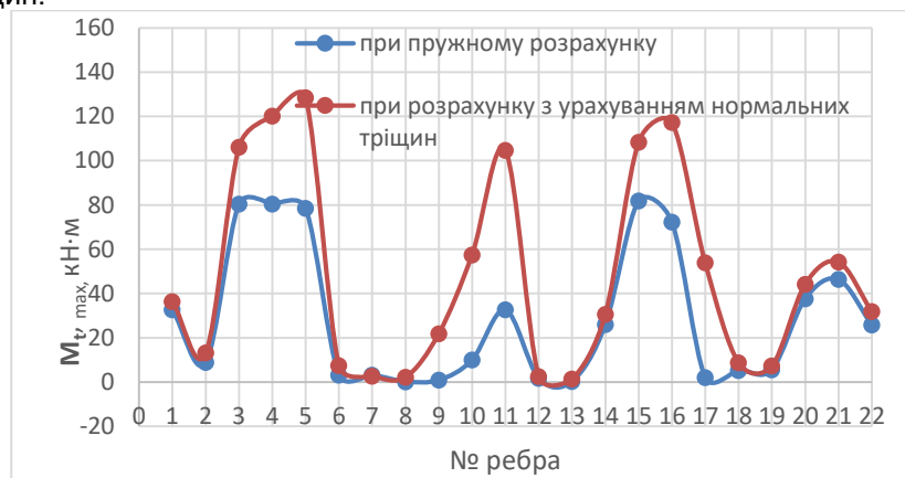
Рис. 1 Максимальні крутні моменти «Mt» для ребристих елементів монолітного залізобетонного перекриття з урахуванням тріщиноутворення та без врахування наявності нормальних тріщин
