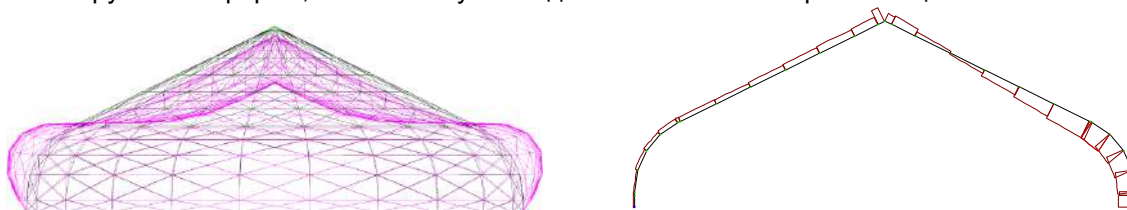
Рис.2 Деформована схема таєпюра зусиль N в найнавантаженішій арці при дії статичних навантажень (РСН1) .
