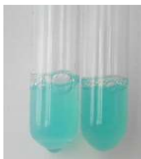
Рис. 1 – Облік реакції з міді сульфатом на бульйоні з м'язової тканини птиці: бульйон прозорий, блакитного кольору
