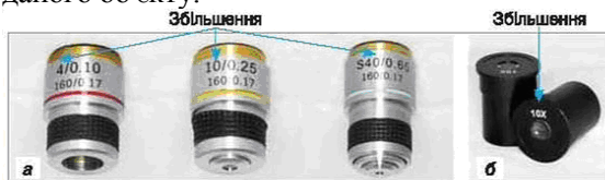
Рис. 6.6.2. Об'єктиви (а), окуляр (б) та їх маркування
