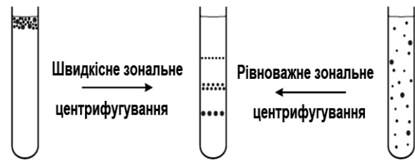
Рис. 5.6.2. Очищення віріонів швидкісним зональним або рівноважним зональним центрифугуванням ( https://mycology.univer.kharkov.ua/wp-content/uploads/2016/05/Virology_lectures.pdf )
